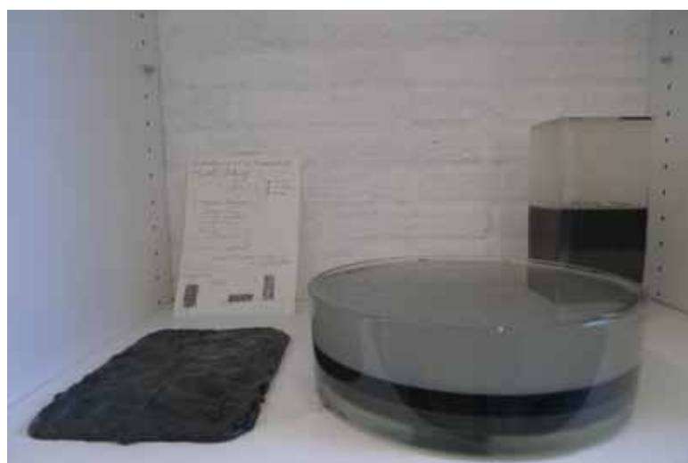
v In en onder de sloot tot 1,20 m diep: ZOut - klei en zand
