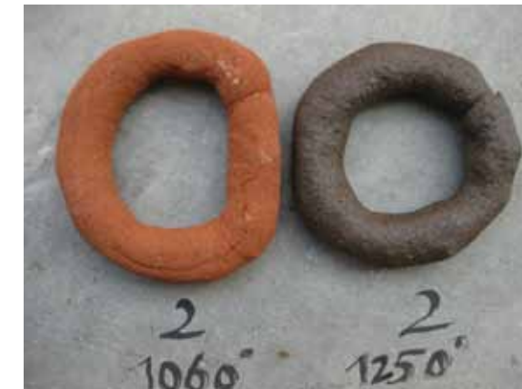
linker ring niet gesinterd op 1060°C, rechts ver gevorderde sintering bij 1250°C
