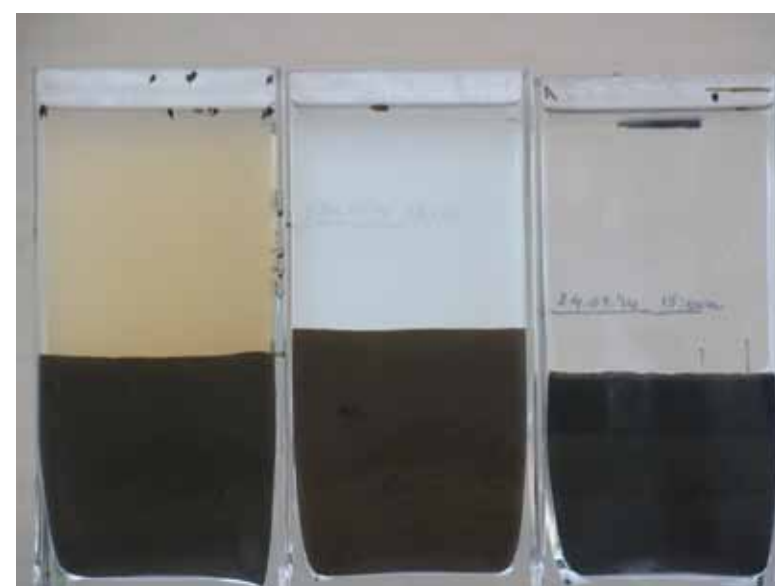
1a 1b 1c bezinkopstelling zes bodemmonsters Schouwen-Duiveland
