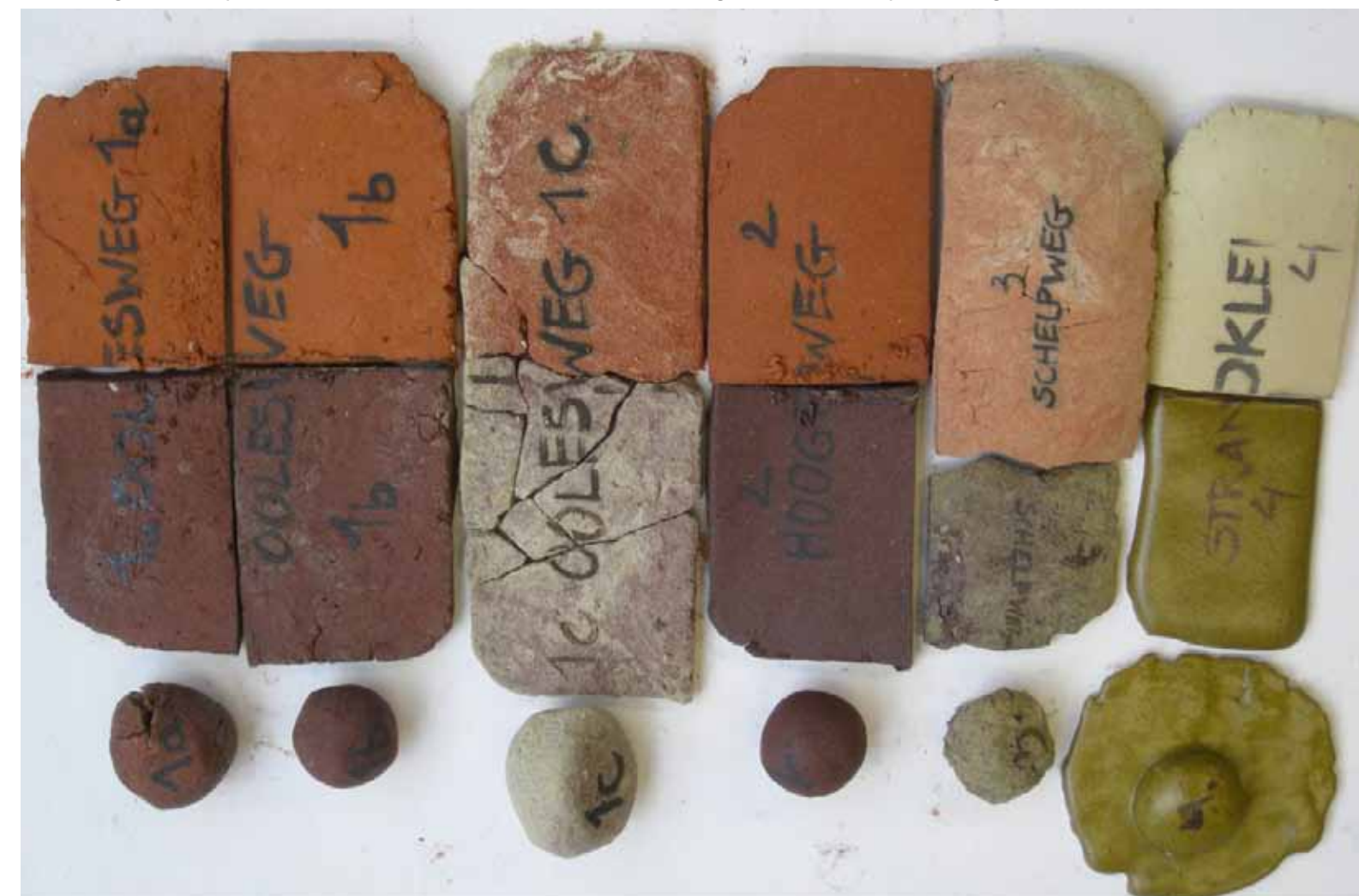
De plasticiteitproefjes zijn ook gestookt op 960°C, 1060°C en, hierboven afgebeeld, op 1160°C.
