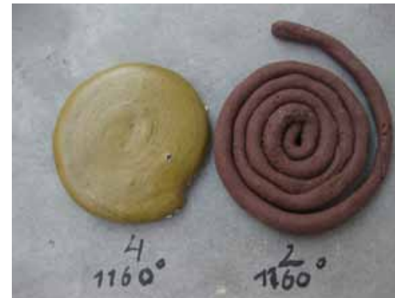
spiraalvorm is nog nauwelijks te zien bij zeeklei (4) op 1160°C gebakken
