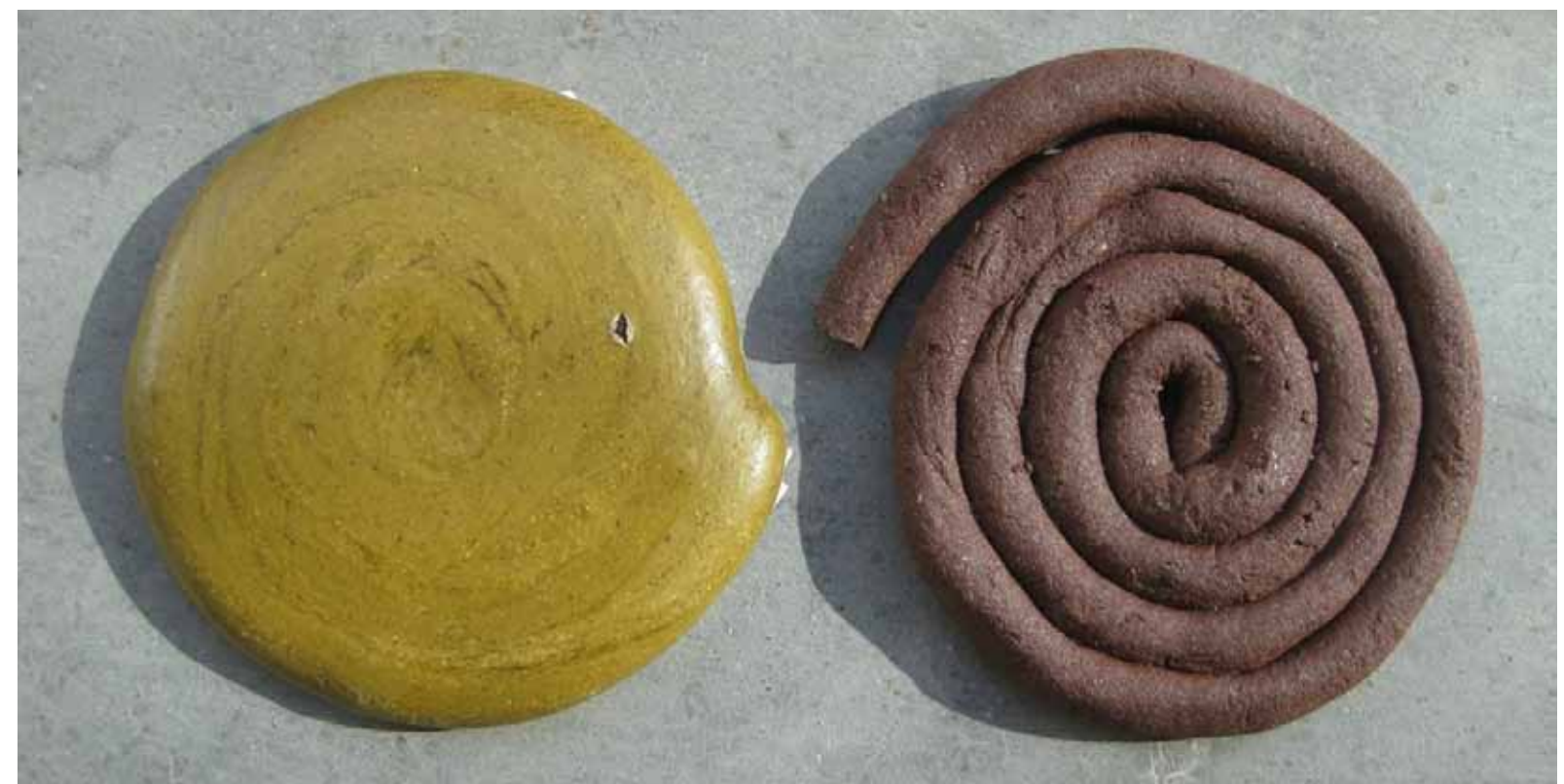
links zoute zeeklei, spiraal gestookt op 1160 graden
