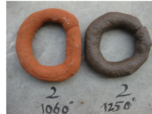
linker ring niet gesinterd op 1160°C, rechts gevorderde sintering bij 1250°C
