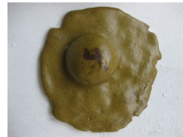
vormverlies goed te zien bij 4 zeeklei op 1160°C
