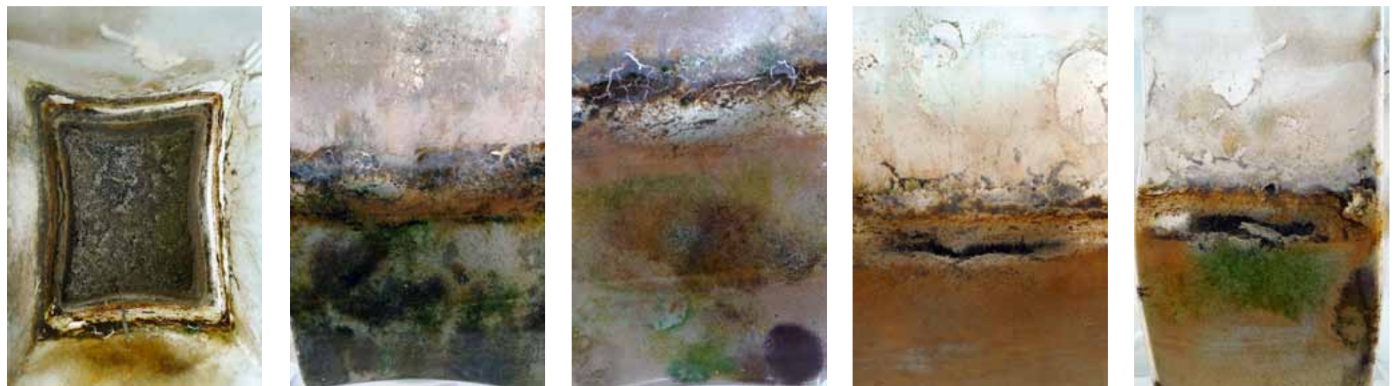
Grondmonster 1 Oolesweg, van boven naar beneden: 1A, de bouwvoor, was zoet , 1B op 1,2 m diep was al brak , en het monster 1c van 2,4 m diepte zout
