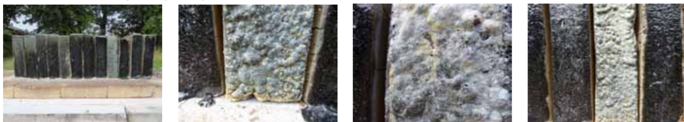
v 12 locale slibs vermengd met potas op de verticale reeks (neveneffect/toeval)
