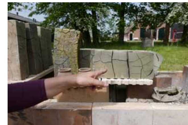
^ midden van oven, 2e laag; gebarsten objecten direct in de vlam
