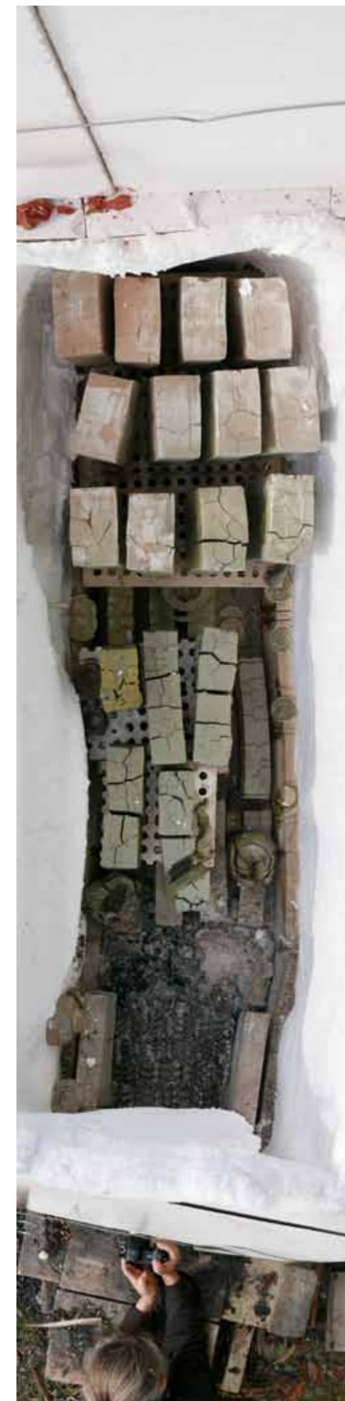
^ bovenaanzicht geopende veldoven, vuurmond onder; verloop van bruin (reductie), via groen, naar oranje-rood (oxidatie)
